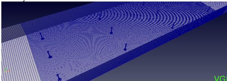
Рис. 8. Расчетная область и сетка с 12 ВЭУ
