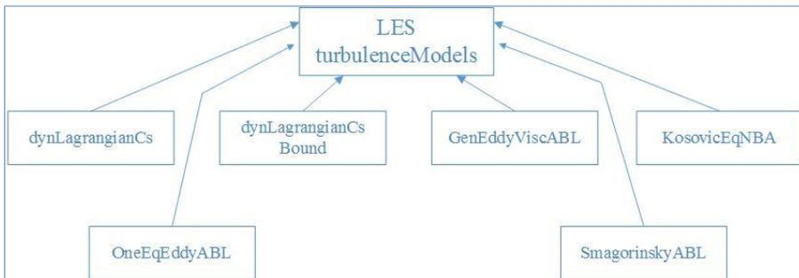
Рис.2 Производные классы SOWFA для описания моделей турбулентности
