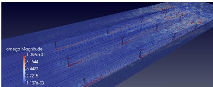
Рис.9 Поле модуля завихренности в момент времени  $t=20$  секунд
