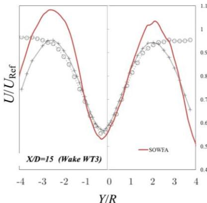
Рис.10. Профиль безразмерной горизонтальной скорости на расстоянии  $X/D=15$ , где  $X$  является расстоянием от ВЭУ,  $D$  является диаметром ВЭУ. Красная линия – расчет с использованием SOWFA, линия с круглыми маркерами – эксперимент для ряда из четырех турбин, линия с крестами – эксперимент для массива из 12 ( $3 \times 4$ ) турбин
