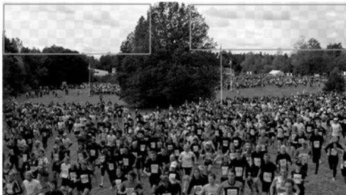
Рис. 5. Сравнение в виде шахматной доски кадра №1 из видеопоследовательности Crowd run до и после выравнивания гистограммы с параметрами kernelsize = 8 и cliplimit = 0.00419 . Обведены области, где разница наиболее заметна
