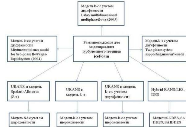
Рис. 3. Различные модели турбулентности в решателе iceFoam
