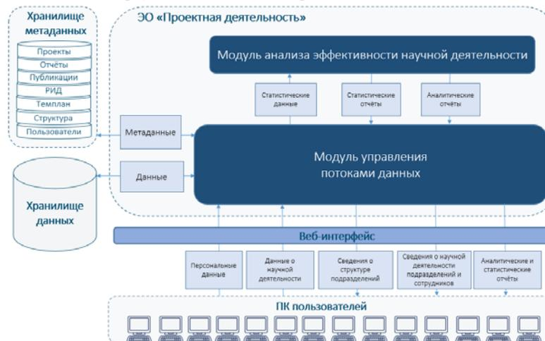
Рис. 5. Компьютерная модель Модуля «Проектная деятельность»
