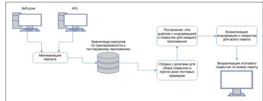
Рис. 1. Общая схема работы системы для сбора покрытия
