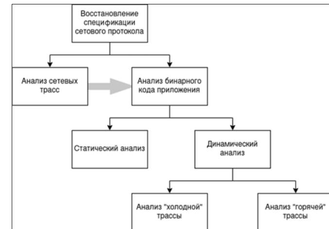
Рис. 1. Способы восстановления спецификаций протоколов и протокольных автоматов
