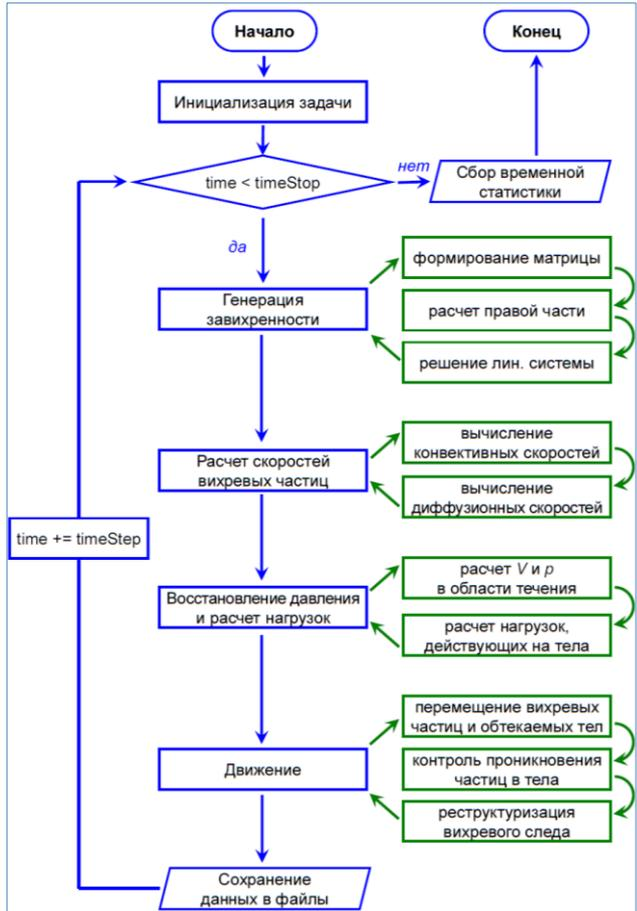
Рис. 1. Общая схема алгоритма вихревых методов
