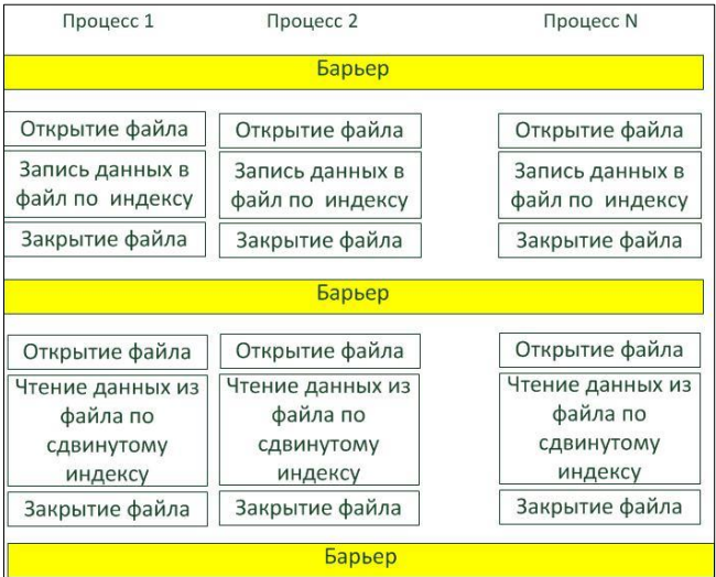
Рис. 3. Схема определения пропускной способности ПФС Fig.3. The scheme of determining Lustre multi-channel bandwidth
