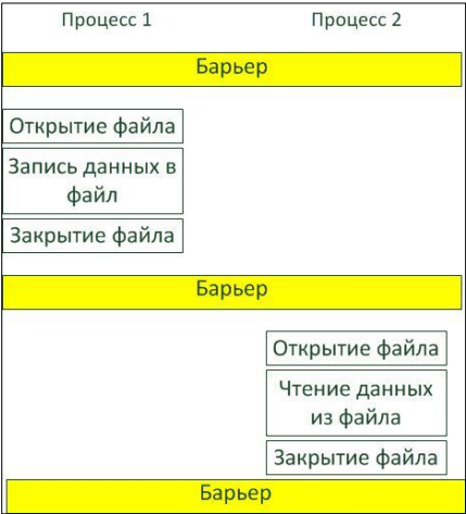
Рис. 2. Схема определения пропускной способности канала ПФС Fig.2. The scheme of determining Lustre channel bandwidth
