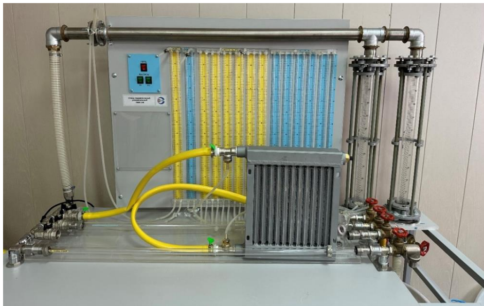
Рис.3. Схема подключения ТА к гидравлическому стенду ТМЖ-2М Fig.3. Connection diagram of the HE to the TMJ-2M hydraulic stand
