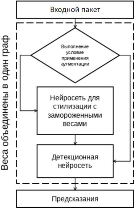
Рис. 3. Схема реализованного подхода применения аугментации Fig. 3. Scheme of the implemented augmentation approach
