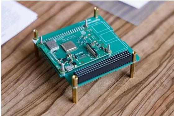
*Рис. 2. Летная модель бортового вычислительного модуля.
