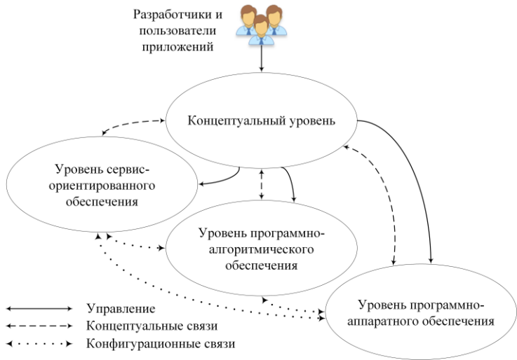
Рис. 2. Уровни архитектуры вычислительной среды сервис-ориентированных приложений. Fig. 2. Architecture layers of computing environment for service-oriented applications.
