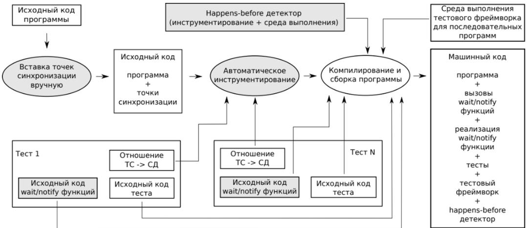
Рис. 2. Компонентная структура фреймворка для тестирования на гонки по данным с автоматическим инструментированием исходного кода вызовами wait/notify функций.
