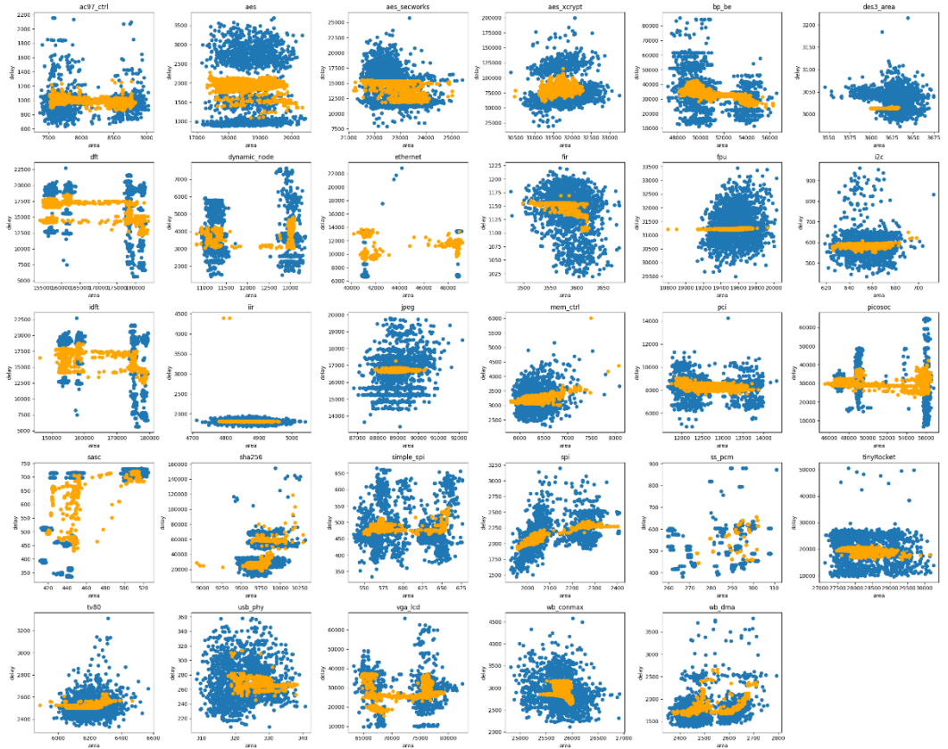
Рис. 2. Реальные (синие точки) и спрогнозированные моделью XG-бустинга (желтые точки) значения характеристик СБИС. Fig. 2. Actual (blue dots) and predicted by the XGBoost model (yellow dots) ASIC characteristics.
