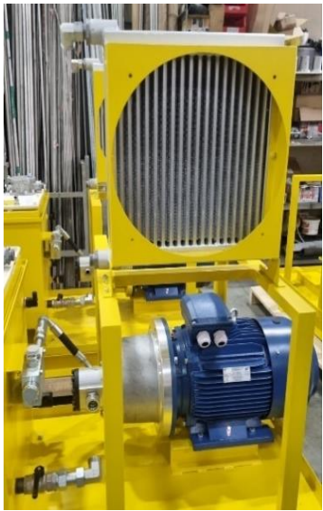
Рис. 1. Маслоохладитель в сборе. Fig. 1. Oil cooler assembly.
