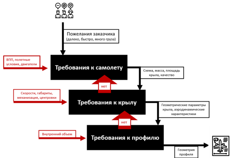
Рис. 4. Декомпозиция требований технического задания при формировании облика летательного аппарата с точки зрения аэродинамического проектирования. Fig. 4. Technical requirements decomposition from aerodynamical design point of view.
