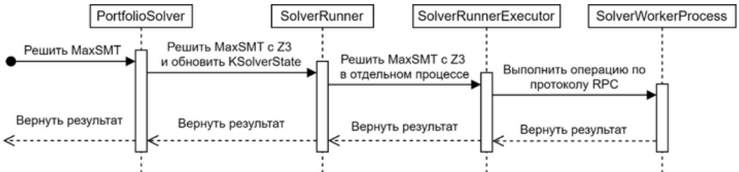
Рис. 2. Работа MaxSMT-решателя в режиме портфолио.
