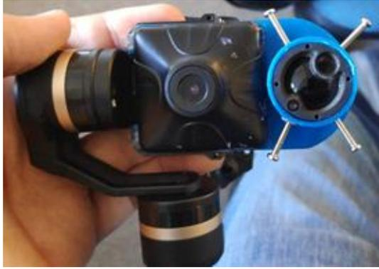
Рис. 3. Подвес с камерой и дальномером.
