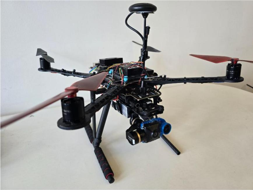
*Рис. 2. Holybro S500 дрон для экспериментов.
