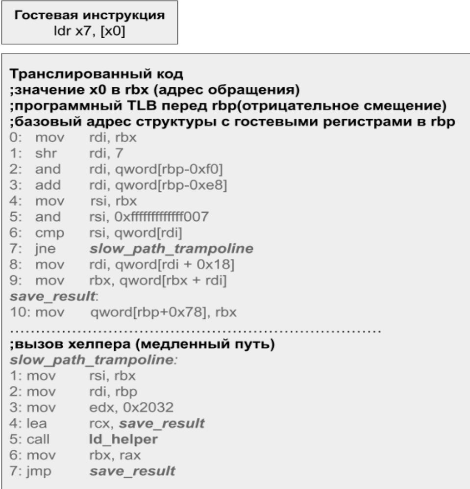
Рис. 1. Транслированный код для инструкции ldr.
