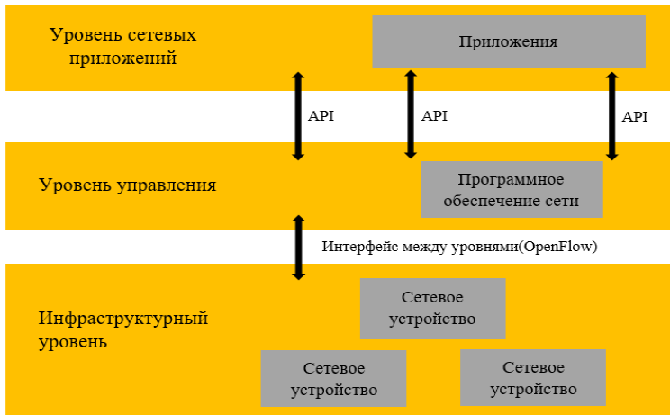
Рис. 1. Архитектура программно-конфигурируемых сетей. Fig. 1. Software-defined networking architecture.
