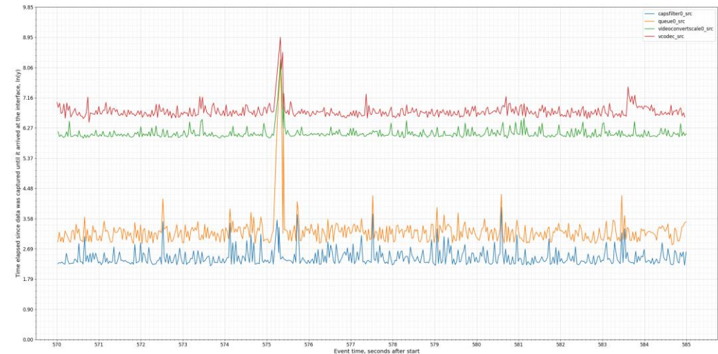
Рис. 8. Фрагмент графика, построенного по данным трассировщика ‘interlatency’ по данным конвейера на основе VP9. Между 575 и 576 секундами трансляции видны аномальные задержки: левее расположен пик, соответствующий задержке выхода данных из кодировщика, далее – задержки объекта конвертации форматов (зелёный) и очереди перед ним (оранжевый). Fig. 8. Fragment of a plot based on data from the “interlatency” tracer of a VP9-based pipeline. Anomalous delays are visible between 575 and 576 seconds: to the left is a peak corresponding to the delay of data exiting the encoder, followed by the format conversion element (green) and the queue preceding it (orange).
