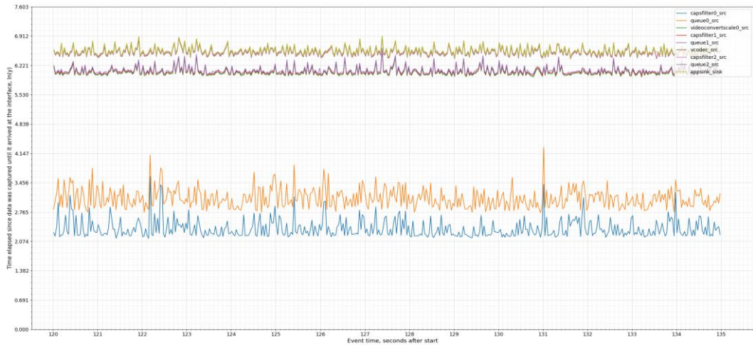
Рис. 6. Фрагмент графика, построенного по данным трассировщика 'interlatency' на основе x264. По вертикали отложен логарифм времени, которое прошло с момента появления данных в начале конвейера до момента их регистрации на некотором интерфейсе некоторого объекта. По горизонтали отмечено время в секундах, прошедшее с момента начала трансляции экрана удалённого рабочего стола. Fig. 6. A fragment of a plot built from 'interlatency' tracer for a x264-based pipeline. The vertical axis represents the logarithm of the time elapsed from the moment data enters the pipeline to its registration on a specific interface of a specific object. The horizontal axis indicates the time in seconds since the start of the remote desktop screen streaming.
