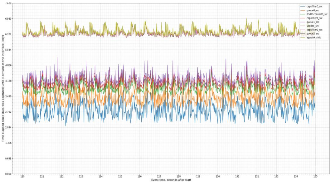
Рис. 5. Фрагмент графика, построенного по данным трассировщика 'interlatency' на основе DirectX. По вертикали: логарифм времени, которое прошло с момента появления данных в начале конвейера до момента их регистрации на некотором интерфейсе некоторого объекта. По горизонтали: время в секундах, прошедшее с момента начала трансляции экрана удалённого рабочего стола. Fig. 5. A fragment of a plot built from 'interlatency' tracer for a DirectX-based pipeline. The vertical axis represents the logarithm of the time elapsed from the moment data enters the pipeline to its registration on a specific interface of a specific object. The horizontal axis indicates the time in seconds since the start of the remote desktop screen streaming.
