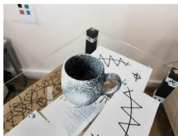
Рис. 4. Объекты на этапе съёмки фотографий для реконструкции материалов и на этапе реконструкции геометрии с различными видами текстурирующих покрытий.
