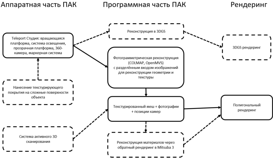
Рис. 2. Архитектура предложенной системы. Пунктиром отмечены необязательные модули для простых текстурированных матовых объектов. Fig. 2. Architecture of the proposed system. Optional modules for simple textured matte objects are marked with dotted lines.
