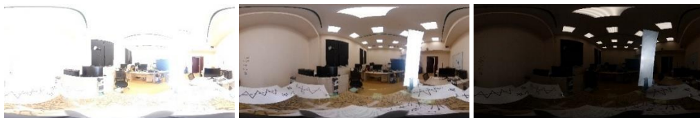
Рис. 6. Панорамные фотографии для построения модели освещения посредством HDR-съёмки на месте объекта с разницей в выдержке более 1000×.
