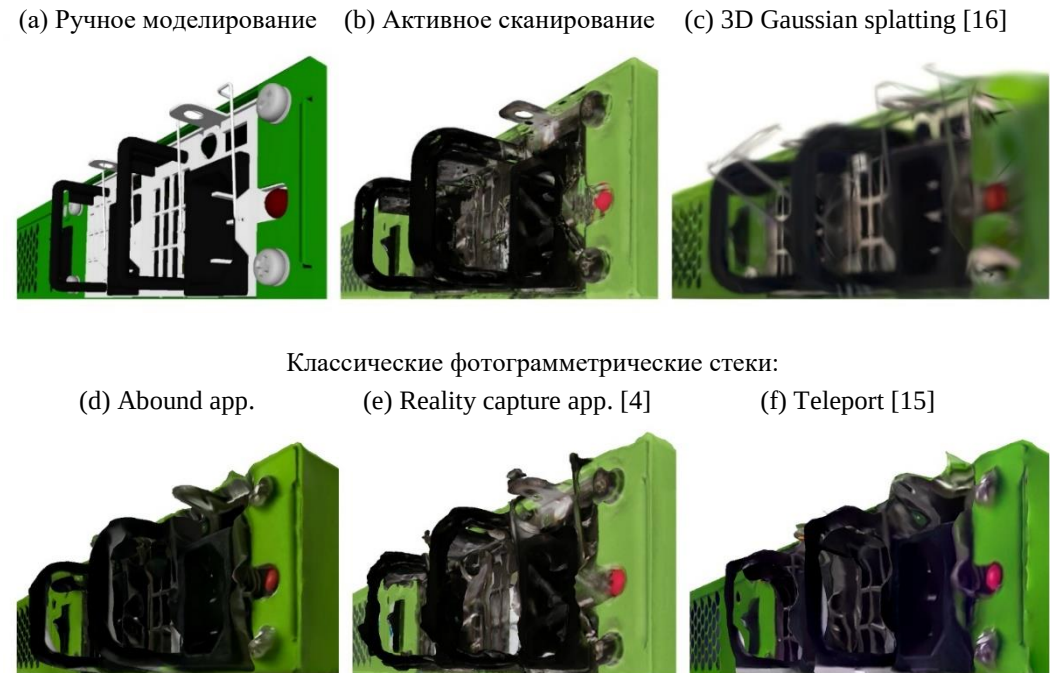
Рис. 12. Сравнение различных методов представления цифровой копии при просмотре участка объекта вблизи. Fig. 12. Comparison of different methods for presenting a digital copy when viewing a section of an object up close.
