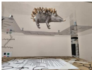
Рис. 5. Полнота охвата поверхности объекта ( 360^{\circ} \times 360^{\circ} ) обеспечивается за счёт вращения стеклянной платформы.
