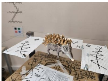
Рис. 5. Полнота охвата поверхности объекта ( 360^{\circ} \times 360^{\circ} ) обеспечивается за счёт вращения стеклянной платформы.
