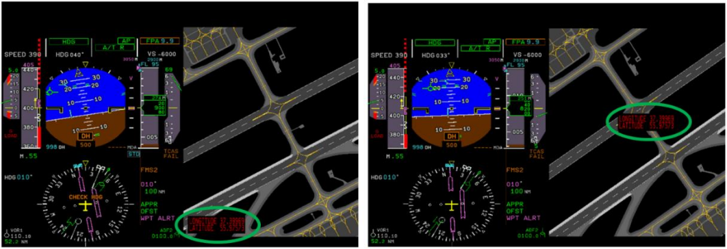
Рис. 4. Два кадра дисплея, сгенерированные из 3-х слоев. Один слой отвечает за перемещаемый текст.
