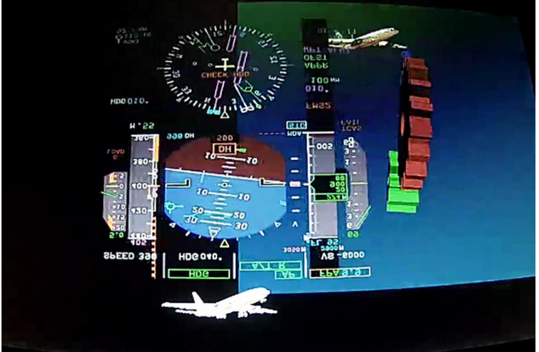
Рис. 5. Фото экрана дисплея, кадр 1. Изображение скомпоновано из четырех слоев. Fig. 5. Photo of the display screen, frame 1. The image is composed of four layers.
