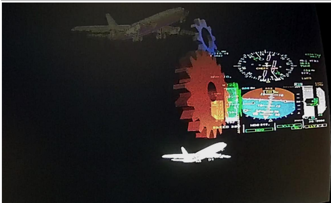
Рис. 7. Фото экрана дисплея, кадр 3. Изображение скомпоновано из четырех слоев. Fig. 7. Photo of the display screen, frame 3. The image is composed of four layers.
