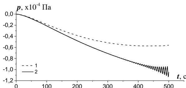
Рис. 3. Эволюция во времени давления в контрольной точке с координатами  $(0,101;0,011)$ : 1 – сетка с минимальным размером ячейки  $0,5 \cdot 10^{-4}$  м в окрестности контрольной точки, 2 –  $1,5 \cdot 10^{-4}$  м
