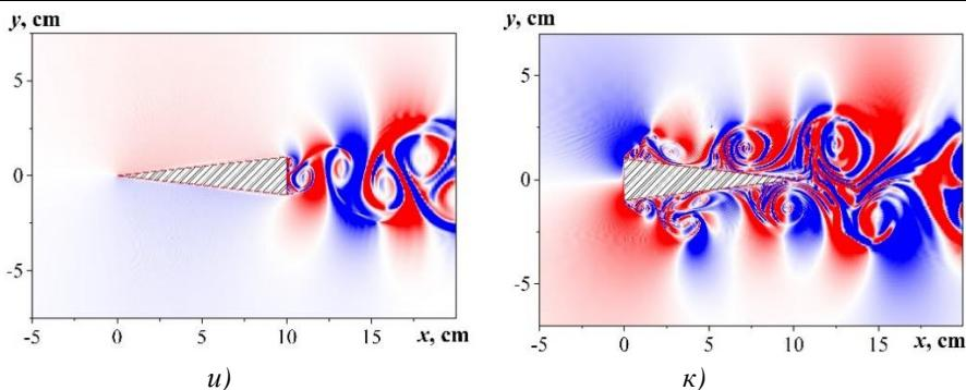
Рис. 5. Горизонтальная компонента градиента возмущения солености  $\partial s/\partial x$  при обтекании клина со скоростью  $U = 10^{-5}$  м/с (а, б),  $U = 10^{-4}$  м/с (в, г),  $U = 10^{-3}$  м/с (д, е),  $U = 10^{-2}$  м/с (ж, з),  $U = 10^{-1}$  м/с (и, к). ( $L = 10$  см,  $h = 2$  см,  $T_b = 6.28$  с, красный цвет – положительные значения, синий – отрицательные)
