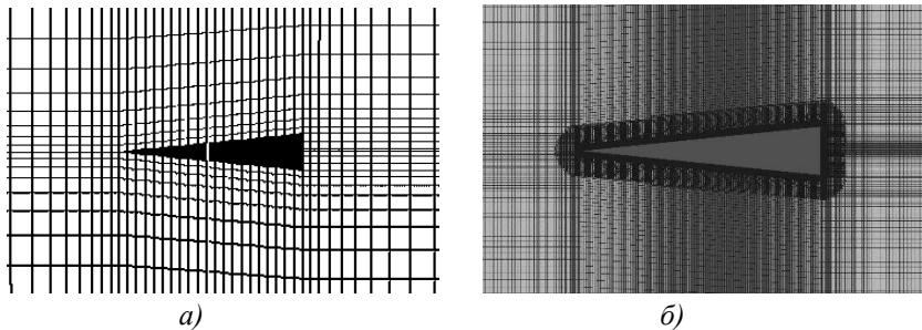
Рис. 4. Схема разбиения расчетной области с линейным сгущением (а) и дополнительным локальным разбиением (б)
