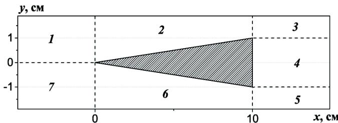
Рис. 2. Схема разбиения расчетной области на блоки
