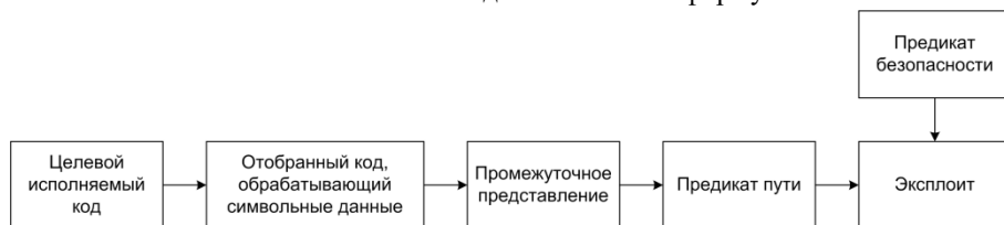
Рис. 1. Последовательность преобразований исполняемого кода при поиске уязвимостей средствами символьного выполнения
