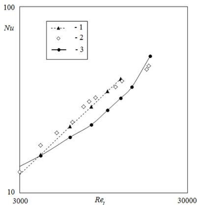
Рис. 3. Данные по теплоотдаче с учетом развития поверхности при наличии выемок: 1 – результаты расчета (12) по критериальной зависимости [20]; 2 – эксперимент КНИТУ им. Туполева-КАИ [20]; 3 – численный расчет авторов в Code Saturne
