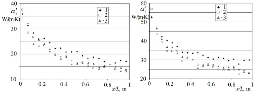
Рис. 5. Коэффициент теплоотдачи (а) для  $Re_l=56391$ , (б) для  $Re_l=112782$ : 1 – подковообразная лунка; 2 – цилиндрическая лунка; 3 – подковообразная лунка, повернутая относительно потока на 45 градусов
