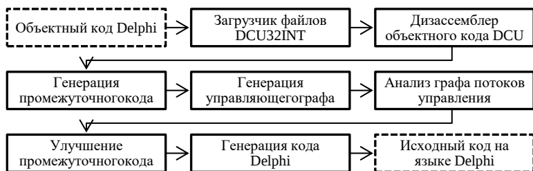
Рисунок 1. Схема декомпиляции объектного кода Delphi
