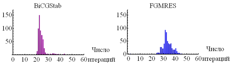
Рис. 1. Гистограмма распределения числа итераций при решении серии разностных аналогов уравнений Гельмгольца методами BiCGStab (слева) и FGMRES (справа) без предобуславливания
