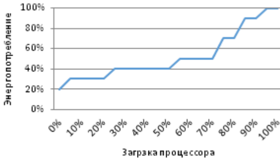
Рис. 2. Энергопотребление в зависимости от загрузки процессора (%).
