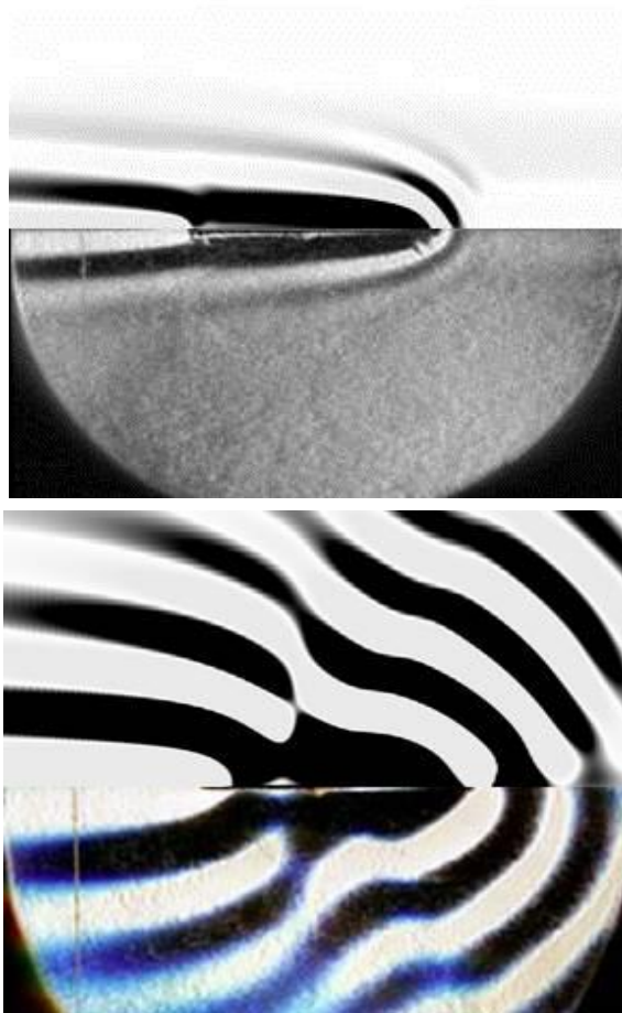
Рис. 7. Рассчитанные поля вертикальной компоненты скорости (верхняя половина изображений) над теневой картиной течения, возникающего при равномерном движении горизонтальной пластины в непрерывно стратифицированной жидкости: a) – U=0.1 см/с, T_b=7.6 с, L_x=7.5 см ; б) – U=0.32 см/с, T_b=7.6 с, L_x=7.5 см.
