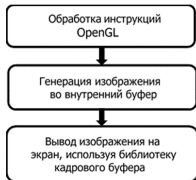
Рис. 1. Схема работы OpenGL для генерации одного кадра Fig. 1. OpenGL working scheme for generating one frame
