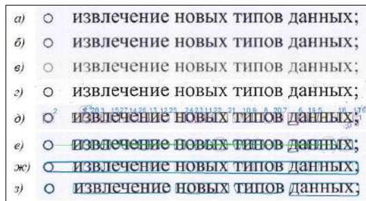
Рис. 3. Результаты выделения строк из изображения Fig. 3. Lines detection results from image
