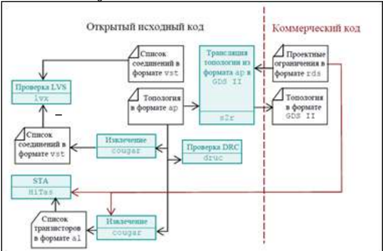
Рис. 5. Этап валидации и получения GDS II-файла в САПР Alliance/Coriolis Fig. 5. Stages of validation and GDS II generation in Alliance/Coriolis
