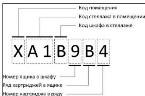
Рис. 12. Схема формирования «адреса» зарегистрированного картриджа
