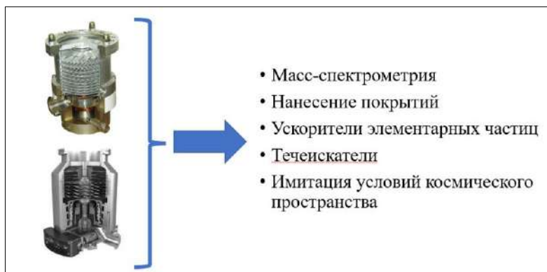
Рис. 1. Области применения ТМН Fig. 1. Applications of turbomolecular vacuum pumps
