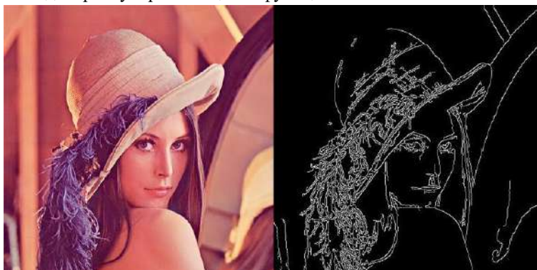
Рис. 4. Обработка изображения детектором Канни Fig. 4. Image processing with the Canny detector
