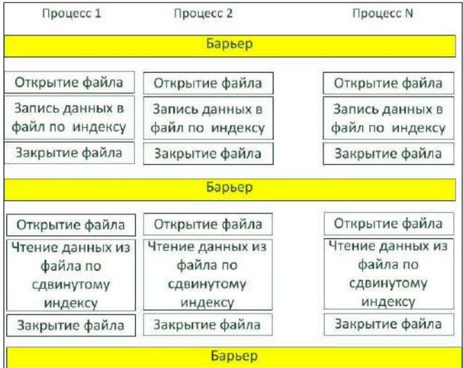
Рис. 3. Схема определения пропускной способности ПФС
