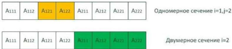
Рис. 8. Порядок хранения элементов трехмерного массива и выбираемого сечения
