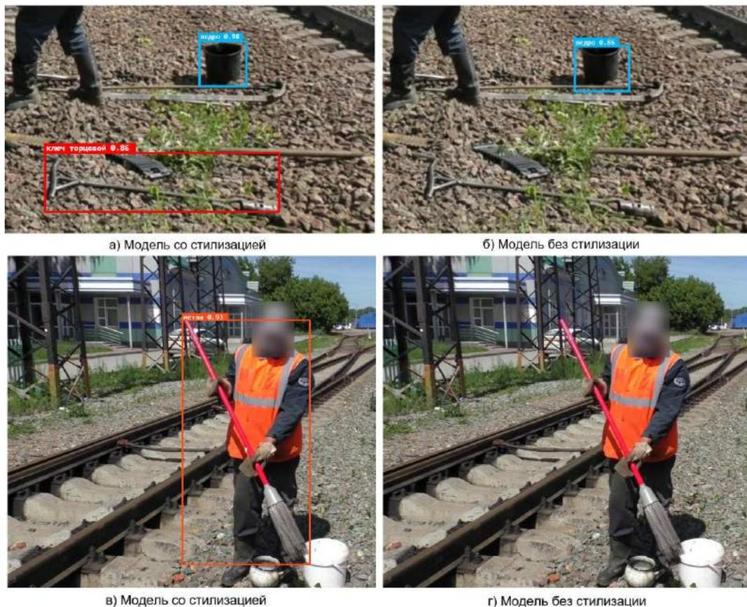
Рис. 7. Пример детекции инструментов
