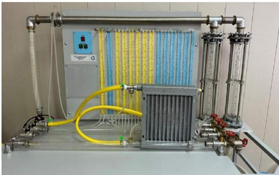
*Рис.3. Схема подключения ТА к гидравлическому стенду ТМЖ-2М*
