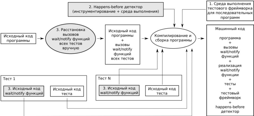
Рис. 1. Компонентная структура фреймворка для автоматизации выполнения тестов на гонки по данным.
