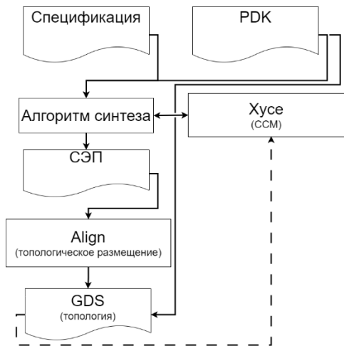
Рис. 4. Маршрут для автоматического проектирования. Fig. 4. Proposed automatic synthesis route.
