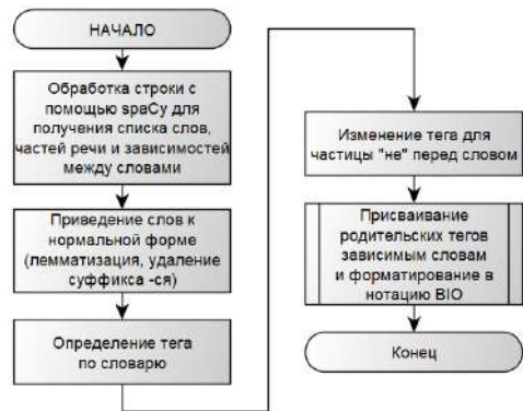
Рис. 1. Структурная схема алгоритма разметки текста словами из словаря. Fig. 1. Block diagram of the text markup algorithm with words from the dictionary.
