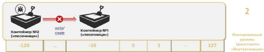
Рис. 3. Схема защиты от «межконтейнерной» атаки. Fig. 3. Protection scheme against "inter-container" attack.
