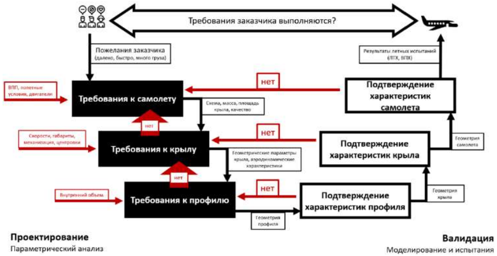
Рис.8. Аэродинамическое проектирование и моделирование в цикле разработки. Fig. 8. Aerodynamical design and simulations during aircraft design process.
