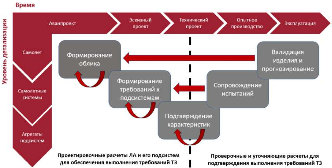
Рис. 1. Расчетные работы в цикле проектирования авиационной техники. Fig. 1. Mathematical calculations and simulations in the aircraft design process.
