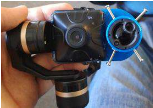
Рис. 3. Подвес с камерой и дальномером. Fig. 3. Gimbal with camera and rangefinder.
