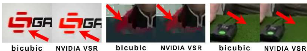
Рис. 1. Примеры искажений, создаваемых NVIDIA VSR, в сравнении с бикубической интерполяцией (bicubic). Первая и вторая пара изображений показывают разницу в цвете. Третья пара показывает, как NVIDIA VSR сильно сглаживает текстуры.
