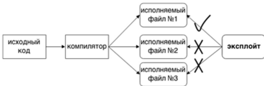
Рис. 1. Схема атаки на диверсифицированную популяцию исполняемых файлов.
