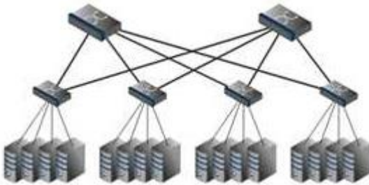
Рис. 1. Топология Fat Tree
