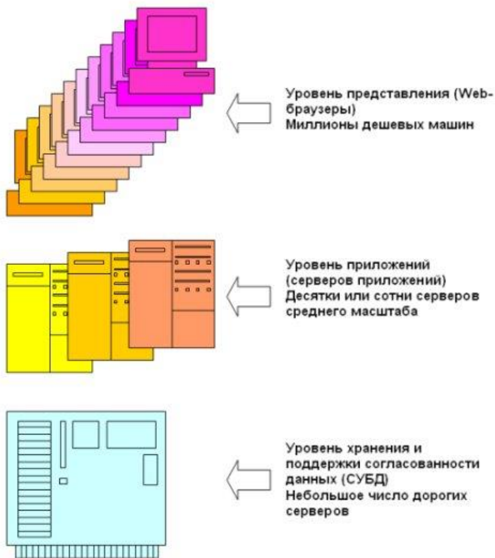
Рис. 9. Традиционная трехзвенная архитектура организации приложений баз данных
