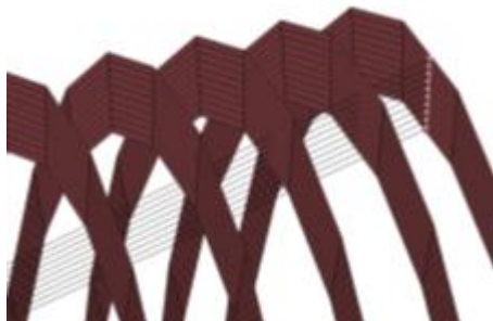
Рис. 5. Диафрагмы бленды и лучи, проведенные от точек на защищаемом диаметре к центрам ячеек на последней диафрагме. Все лучи, кроме двух нижних, пересекаются другими диафрагмами
