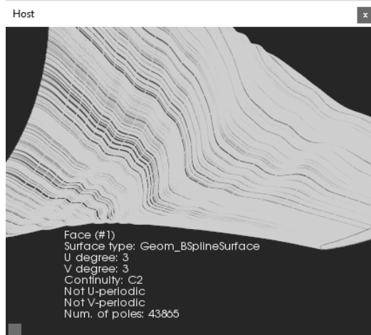
Рис. 12. Поверхность лопатки, построенная скиннингом после унификации профильных кривых. Изолинии отвечают узловым значениям базисных сплайнов. Видны характерные сгущения.
