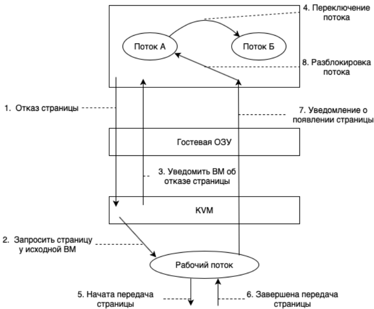
Рис. 1. Процесс обработки ошибки страницы в гипервизоре Fig. 1. The processing of page faults in the hypervisor
