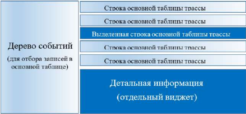
Рис. 1. Отображение детальной информации выделенной записи в отдельном виджете Fig. 1. Visualization of selected record details by standalone widget
