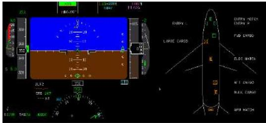
Рис. 11. Многооконный дисплей двух приложений: PFD и состояние дверей
