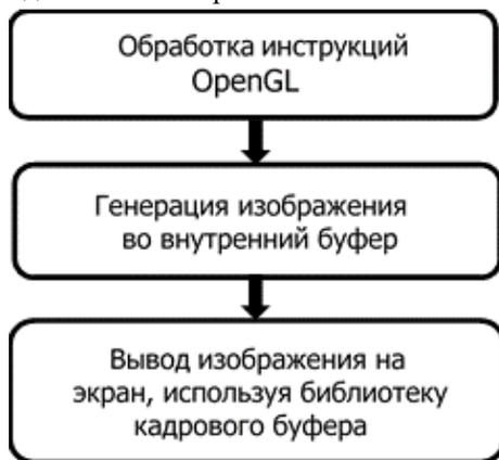
Рис. 1. Схема работы OpenGL для генерации одного кадра
