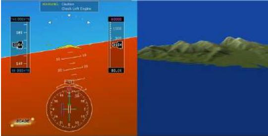
Рис. 10. Многооконный дисплей двух приложений: GlassCockpit и рельеф местности
