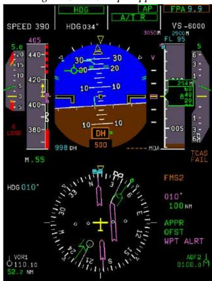
Рис. 4. Основной дисплей полета (PFD)
