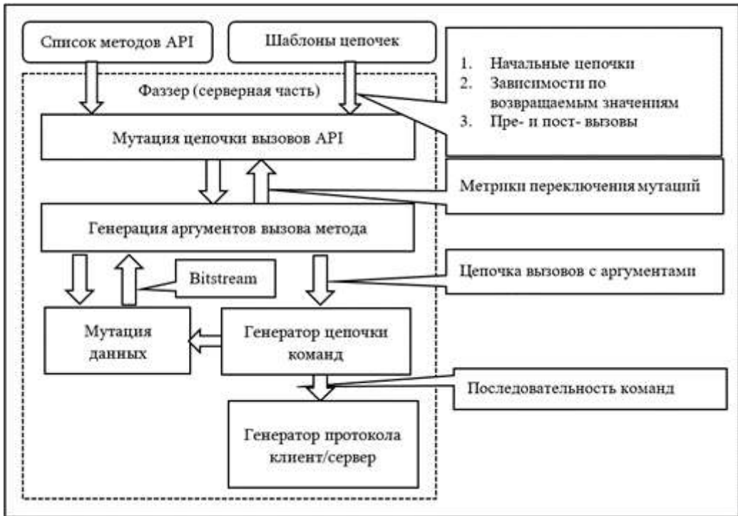
Рис. 3. Схема основного цикла фаззинга на серверной машине Fig. 3. The scheme of the main fuzzing cycle on the server machine
